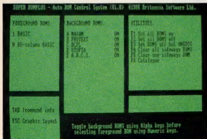
Bild 3. Das Menü des ROM-Box-Betriebssystems, das nach Einschalten des Computers erscheint
